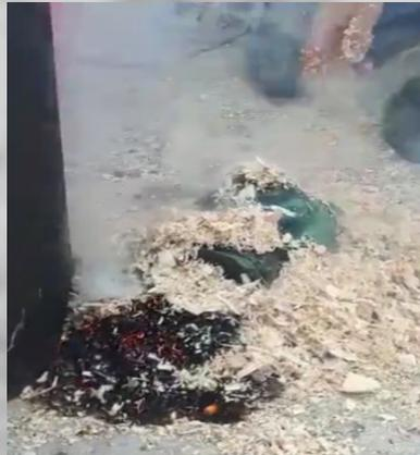
La seconda cottura può essere effettuata senza disporre, necessariamente, di un contenitore, ad esempio, in questo caso, il pezzo viene fatto cuocere semplicemente continuando a cospargerlo di segatura per attivarne la riduzione .
